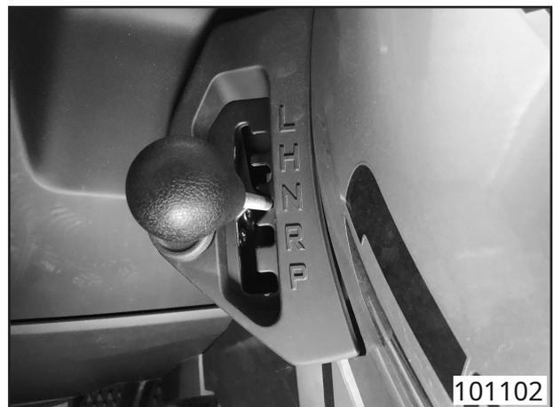
Aflojar dos tuercas 3. Ajuste la posición de la palanca repetidamente hasta que el eje de cambio esté en la posición N de marcha.
